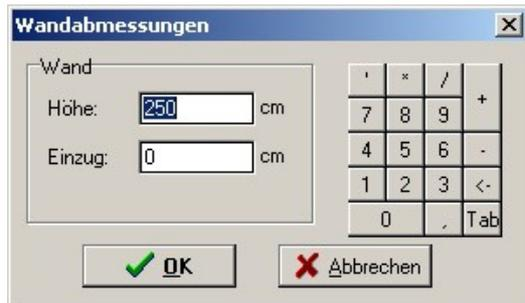
La altura es la altura real del muro. Con la ayuda del campo de entrada "sangría" puede introducir muros que comiencen en diferentes niveles. Si una pared tiene una "sangría" de 0 cm y una segunda pared tiene una "sangría" de 50 cm, entonces la segunda pared comienza 50 cm por encima de la primera. La altura del muro se mide desde este punto.
