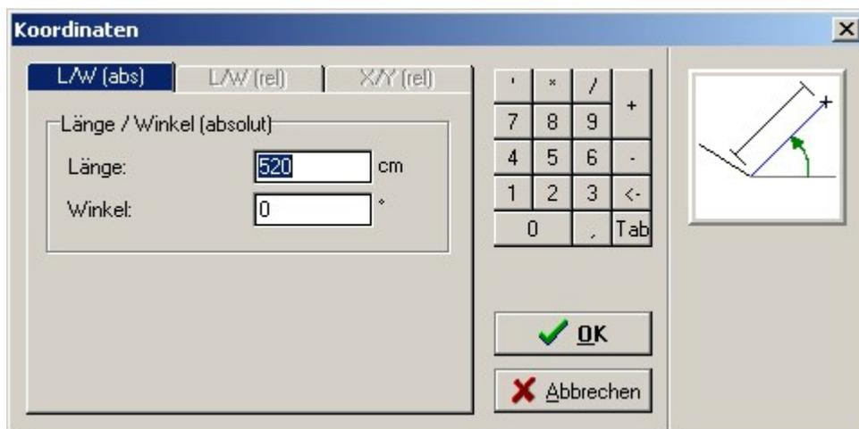
La longitud y el ángulo deseados pueden introducirse en los campos de entrada correspondientes. El ángulo es de 0° para los haces de yugo que apuntan exactamente en la dirección del haz de yugo de la superficie.
