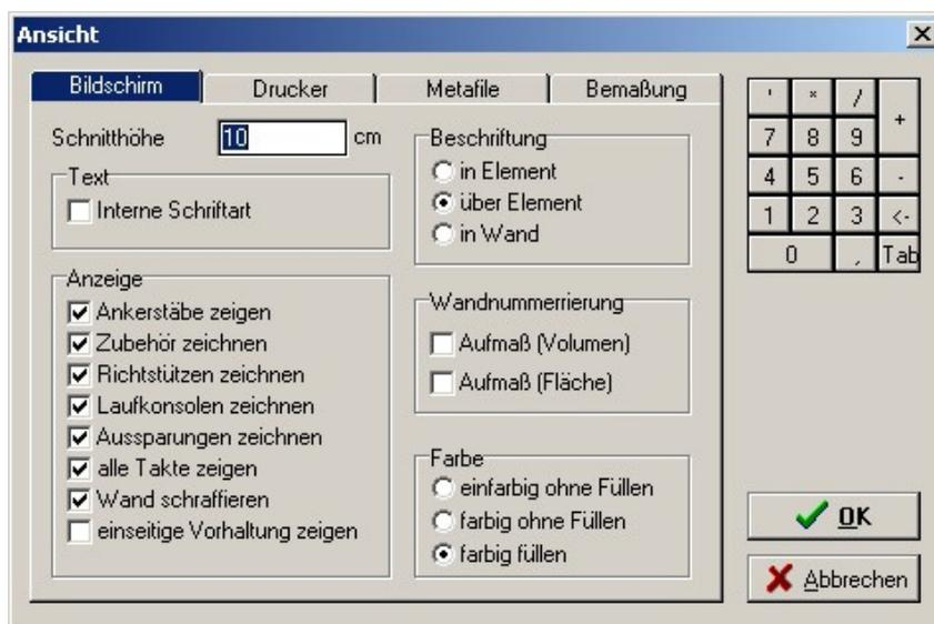
La visualización puede ajustarse para los distintos tipos de salida a través de las pestañas "Pantalla", "Impresora" y "Metafichero".
