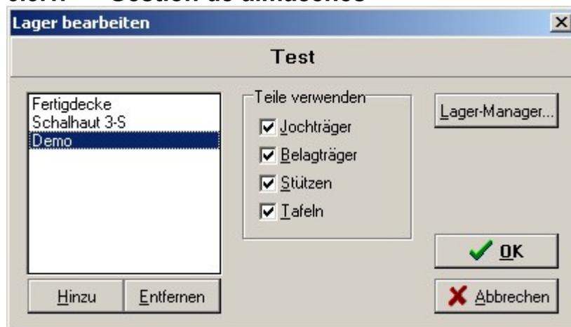
Antes de encofrar un forjado por primera vez, hay que crear un rodamiento. Este stock debe contener el material que se va a utilizar. Antes del primer encofrado, si todavía no existe ninguna acción, se le pedirá que cree una acción. Para ello, se abre la gestión del almacén.
