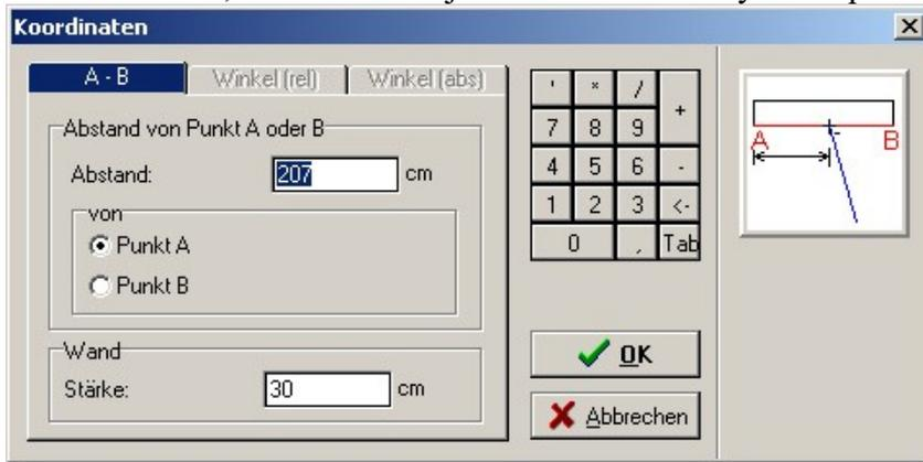
Además, se abre una ventana de diálogo en la que puede especificar la distancia del nuevo muro medida desde uno de estos puntos "A" o "B". Esta medida se refiere siempre a la línea dibujada en verde del muro. Si la segunda línea se encuentra en el lado equivocado de la línea verde, esto se puede cambiar con el comando "Cambiar lado de la pared".
