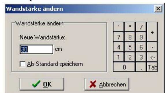
Guardar" puede especificar si el grosor del muro que acaba de introducir se aplica sólo al muro que está dibujando o a todos los siguientes.
